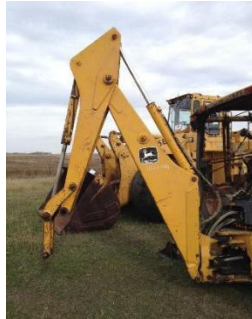
Gambar 30. Bucket Backhoe terlepas
