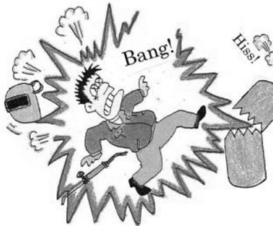
Gambar 41. Tabung Acetylene Bocor dan Meledak.
