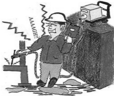
Gambar 40. Kabel Mengelupas dan Terkena Air.
