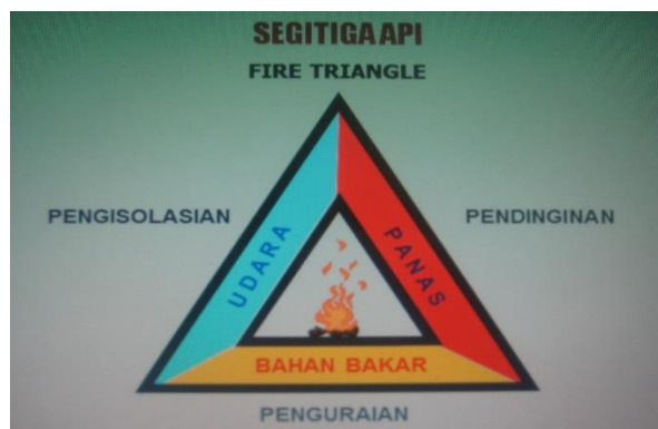
Gambar 12. Pencegahan Pertumbuhan Api Kebakaran
