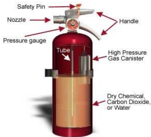
Gambar 10. Bagian-bagian Tabung APAR
