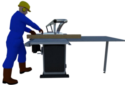
Gambar 3.11 Memotong dan Membelah Kayu Menggunakan Mesin Gergaji Meja
