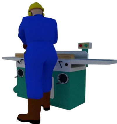
Gambar 3.10 Mengetam Kayu dengan Mesin Ketam Perata
