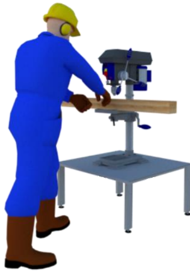
Gambar 3.15 Membuat Lubang dengan Mesin Bor
