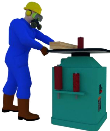
Gambar 3.17 Menghaluskan Permukaan Benda Kerja dengan Menggunakan Mesin Ampelas
