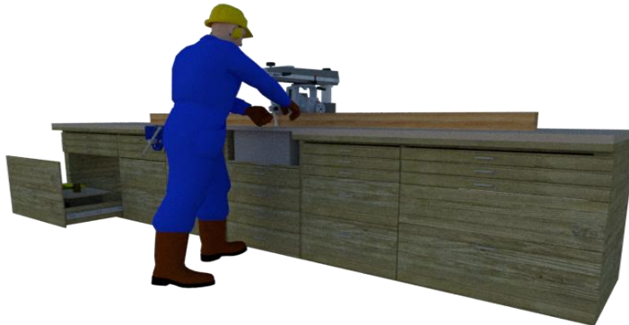
Gambar 3.9 Memotong Kayu dengan Mesin Gergaji Lengan
