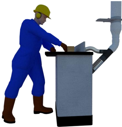
Gambar 3.16 Membuat Porus Benda Kerja dengan Mesin Pembuat Porus Kayu
